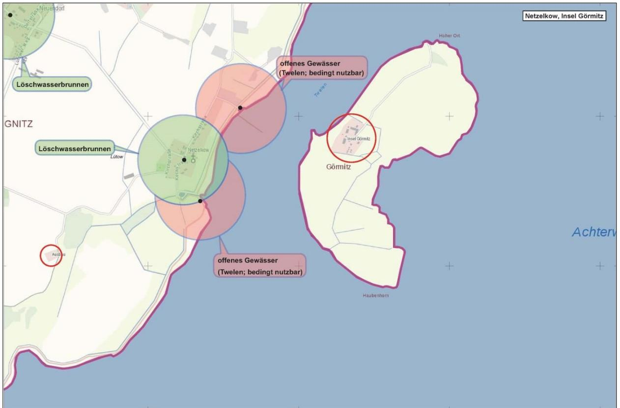
Abbildung 08: Löschwasserversorgung Netzelkow, Insel Görmitz
